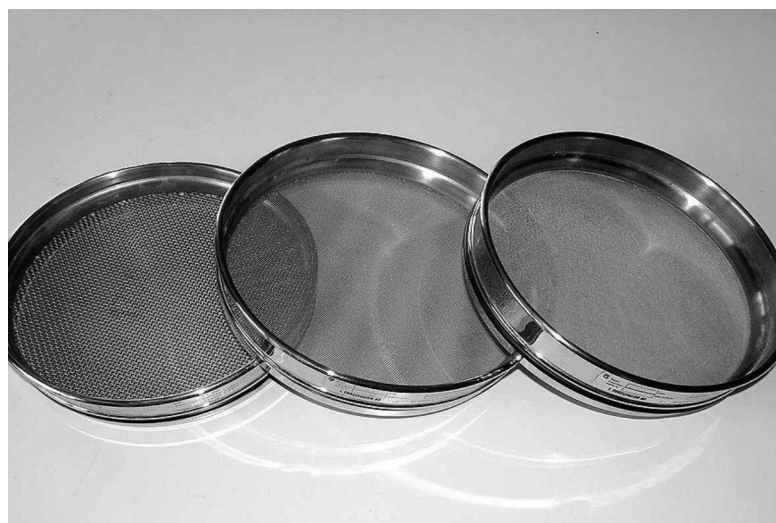
شکل (۱۵): الک‌های مورد استفاده در آزمایش دانه‌بندی در آزمایشگاه مکانیک خاک
