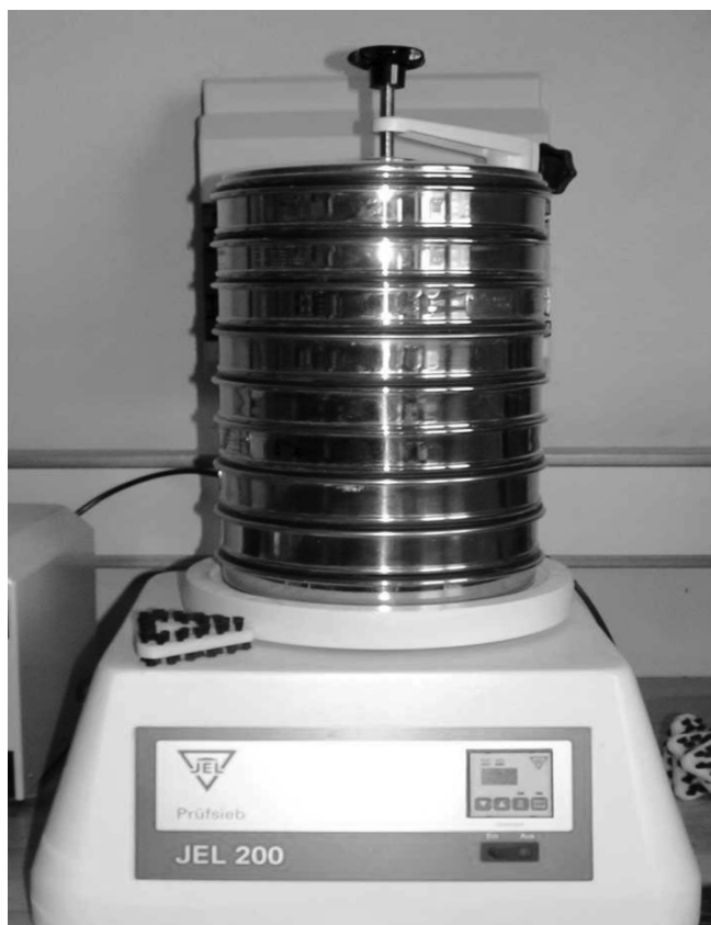
شکل (۱۷): غربالگر shaker مورد استفاده در آزمایش دانه‌بندی خاک در آزمایشگاه
